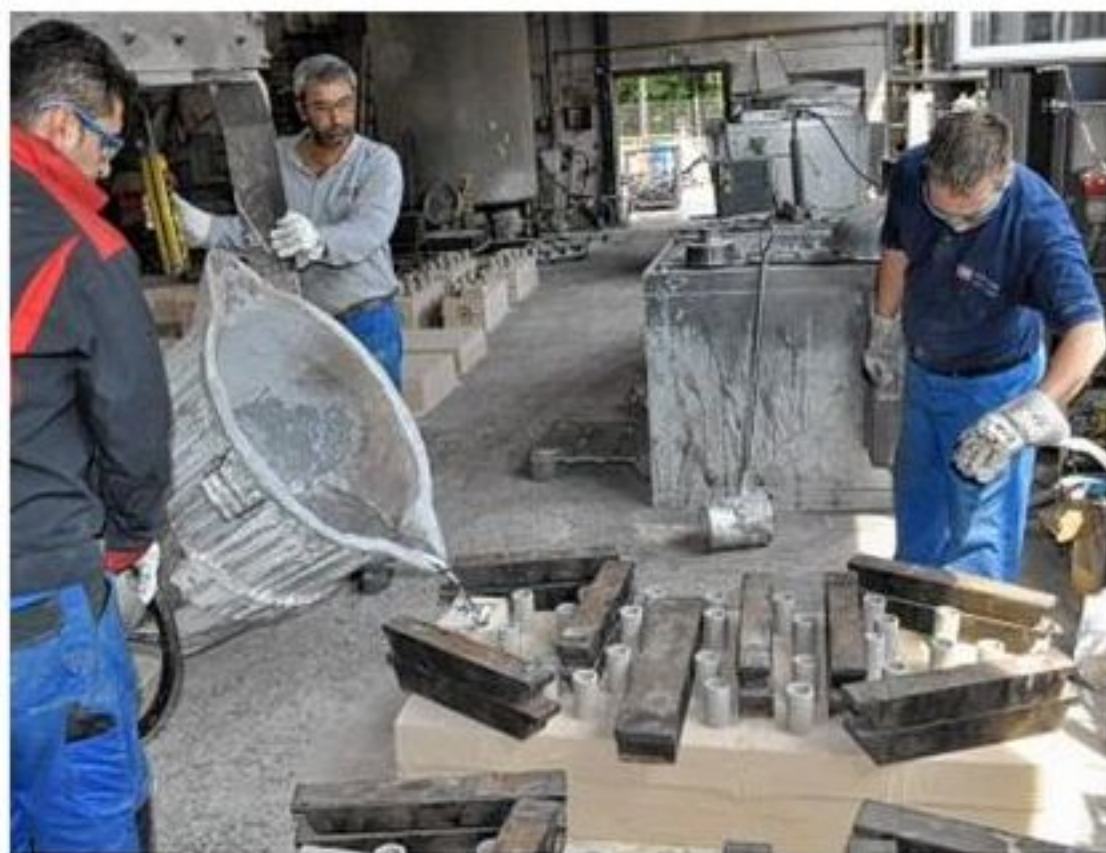
750 Grad heißes flüssiges Aluminium wird von Mahmood Hardawan Hawas, Fikret Zararsiz und Dennis Kunze in eine Sandform (Bild links) gefüllt – Adem Kopic und Vasileios Balntoumis befüllen eine Kokille, eine Gussform aus Stahl (Bild rechts).
