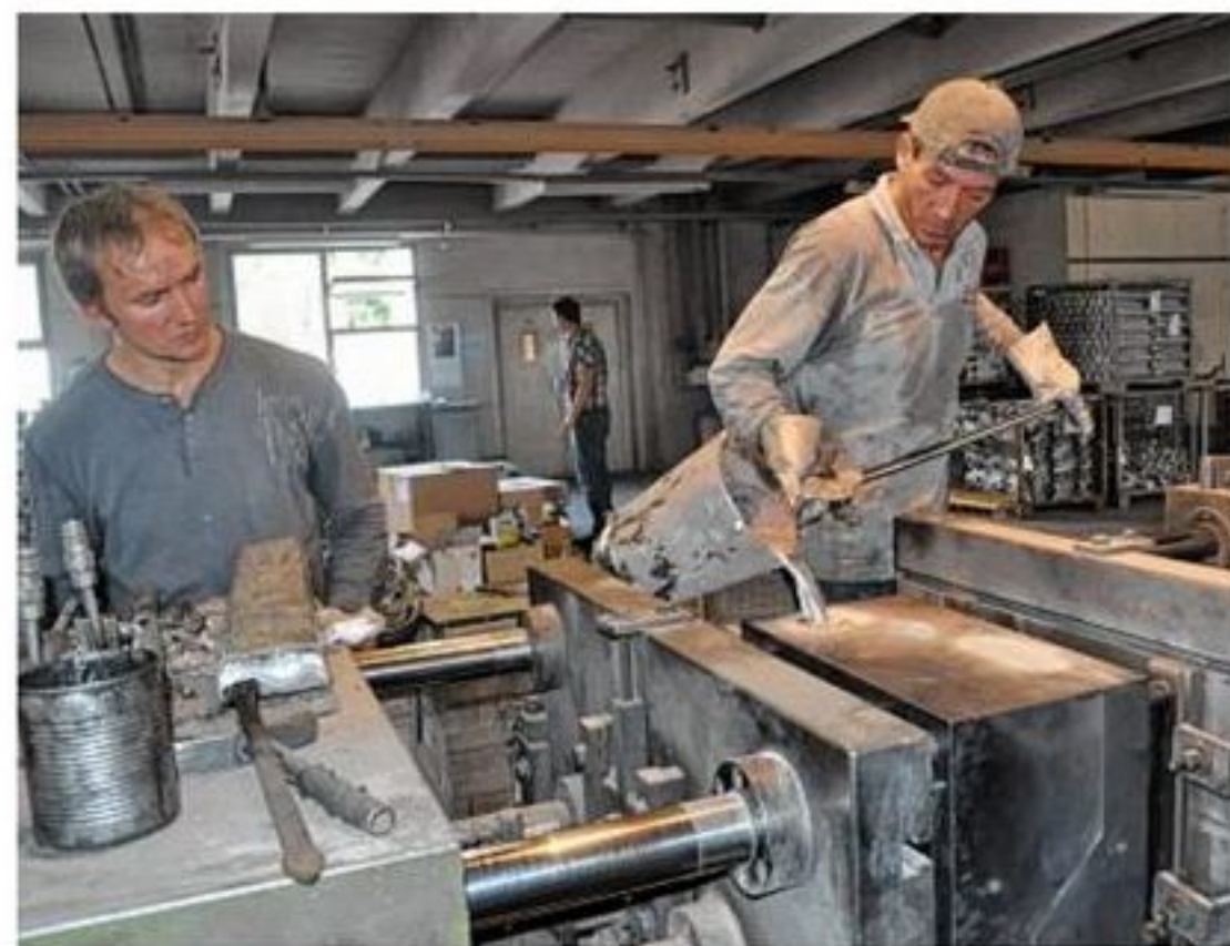
750 Grad heißes flüssiges Aluminium wird von Mahmood Hardawan Hawas, Fikret Zararsiz und Dennis Kunze in eine Sandform (Bild links) gefüllt – Adem Kopic und Vasileios Balntoumis befüllen eine Kokille, eine Gussform aus Stahl (Bild rechts).
