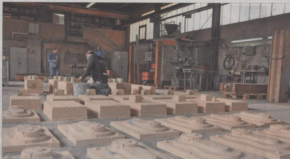
In der Sandgießerei werden die Formen im Handformverfahren selbst hergestellt. Sie entstehen aus einer Mischung aus Quarzsand und Wasserglas. – Fotos: nil
