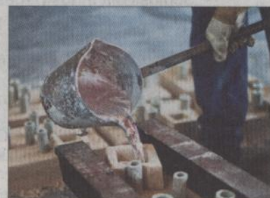
Das rund 750 Grad heiße flüssige Aluminium wird bei kleineren Formen per Hand eingegossen.
